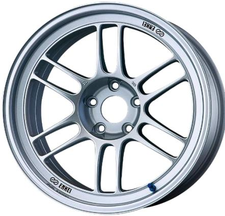
2002年の発売以来、エンケイの軽量ホイールとして圧倒的な人気を誇り、売り上げナンバーワンの「RPF1」。マクラーレンF1マシン用ホイールを踏襲し、応力分散とブレーキ放熱に優れた2×6のマルチスポークデザインが特徴だ。数々のレースからフィードバックされた同社独自のリム形成技術「マッドプロセス」でリムを薄肉化し、大幅な軽量化を実現している。また最新技術を用いた派生モデルも誕生するなど、走りを脚元から支えている。
