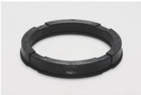
アフターアルミホイールの多くは、センター部（ハブ部）に溜まる水をホイール外に排出できる構造を採用しているが、従来のハブリングを装着すると水を排出しづらく、腐食や錆、汚れの原因となっていた。ハイブリッドハブリングは、水抜けガイドの切り込みを入れ効果的に排水する構造を採用し、4月に特許を取得した。大雨の多発でハブ部に水が入り込む可能性も高まっている現在、ホイール販売時のプラスワン提案として活用できる点を評価した。
